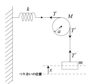
問3 図に示したおもり側の糸の張力 T'を用いて、おもりと滑車に関する運動方程式をそれぞれ書け。また、導出した 2つの運動方程式から T'を消去し、得られた運動方程式を  $m, M, k, x, \ddot{x}$  を使って書け。
