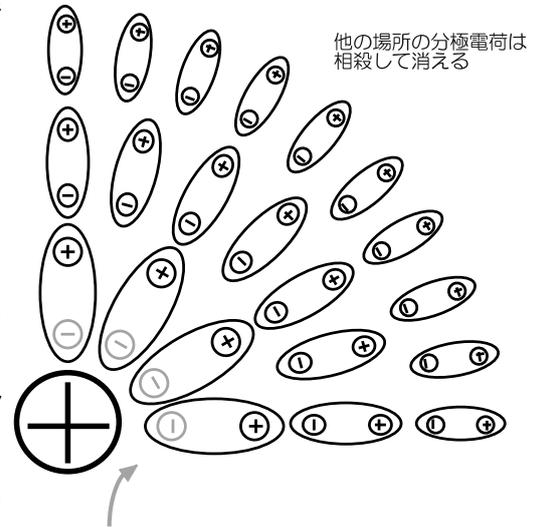
この部分の分極電荷だけが消えずに残る
