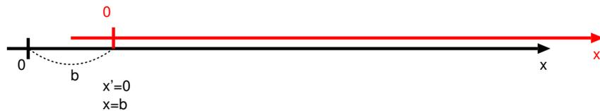
まず簡単な座標変換として、原点の移動を考えよう。新しい座標系  $x'$  系の原点が古い座標系  $x$  系で表して  $x = b$  という場所にあるとする。座標系の向きと目盛りの幅は同じであるとする、この二つの座標系は  $x' = x - b$  という関係で結び付いていることになる。この場合、二つの座標原点は互いに運動していない。 $x'$  座標系の原点は  $x$  座標系の原点よりも右 (つまり、正の方向) にあるのだが、式の上では  $x' = x - b$  と引き算される形になっている。この式になっていると、 $x' = 0$  が  $x = b$  に対応するのだからもちろんこれでいいのだが、勘違いして  $x' = x + b$  とやってしまうことが多いので注意しよう。
